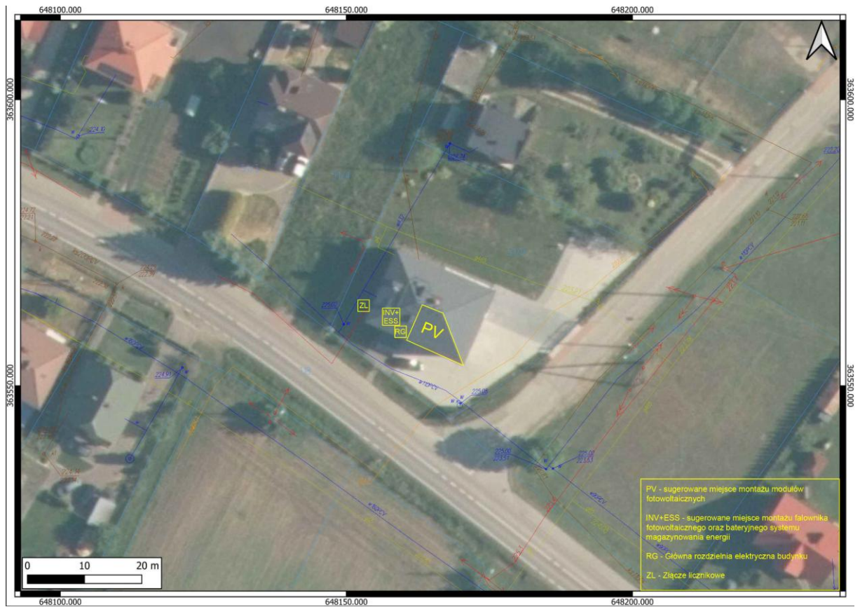
Rysunek 3.2 Lokalizacja złącza licznikowego i rozdzielnicy głównej oraz preferowana lokalizacja instalacji PV
